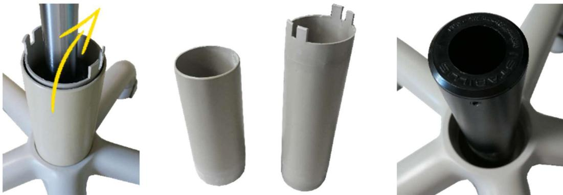
Am unteren Ende der Gasdruckfeder befinden sich vier Aufsätze. Diese liegen meist in der Halterung der Gasdruckfeder und müssen ausgeschüttelt werden. Die Teile werden nicht weiter benötigt. Die Öffnung der Halterung der Gasdruckfeder anschließend sauber wischen.
