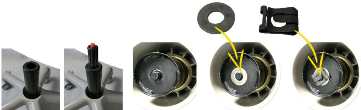
Die beiden Rohrblenden wieder aufsetzen.
