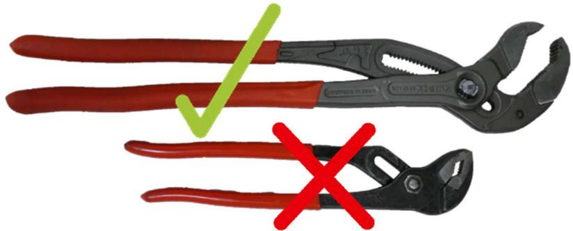
Die Gasdruckfeder mit der Rohrzange greifen und versuchen durch Hin- und Herbewegungen die Gasdruckfeder aus der Verklebung zu lösen. Das ist mühselig und gelingt nicht immer im ersten Versuch.
